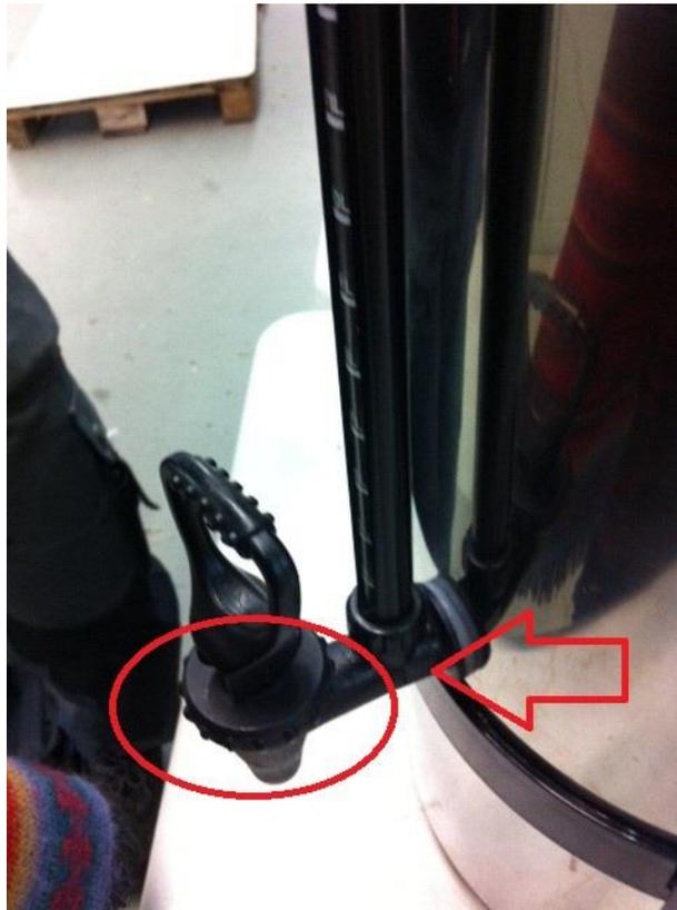
Sollte beim Befüllen des Gerätes Flüssigkeit austreten, kann am Ring des Ausgusshahns selbst gedreht werden, damit sich die Dichtung wieder schliesst.
